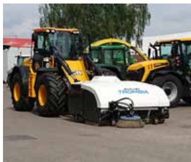
Vårrengjøring og fjerning av sand og støv etter vinteren.
