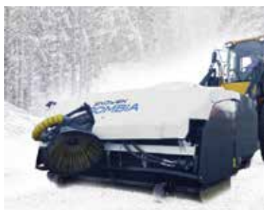
Feing i temperaturer under null. Trombia bruker ikke vann som kan fryse på bakken!
