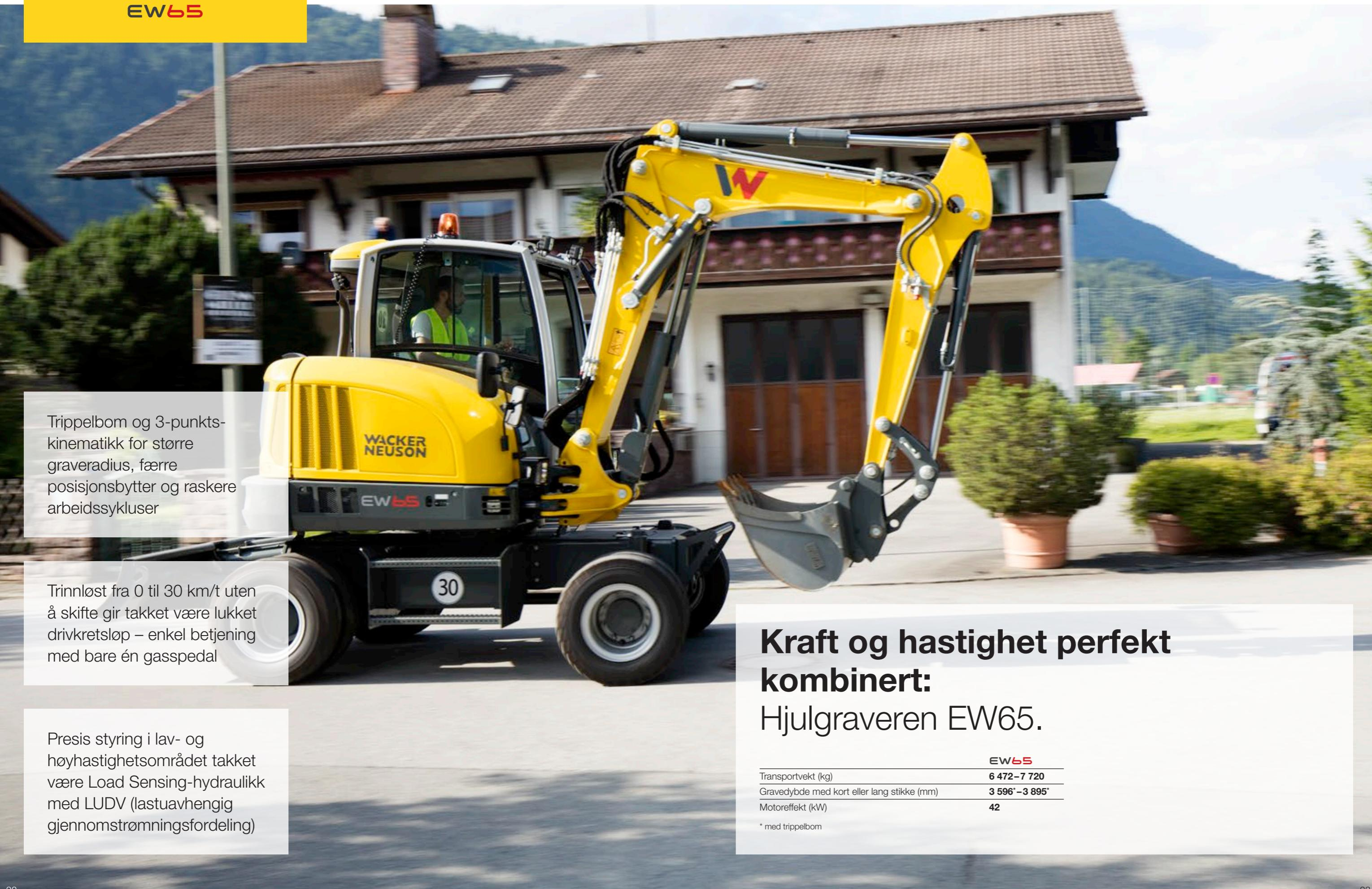
Trippelbom og 3-punkts-kinematikk for større graveradius, færre posisjonsbytter og raskere arbeidssykuler
