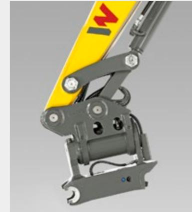
Powertilt med hydraulisk hurtigkobling Easy Lock.
